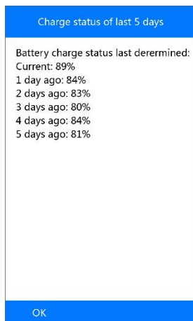
Figura 5-52 Esempio schermata Stato di carica batteria ultimi 5 giorni
