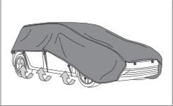
Fissare l'altro lato del velcro nella posizione corrispondente dell'anello di tessuto. (La lunghezza del velcro NON deve essere inferiore a 20 cm per garantire una forza di fissaggio sufficiente)
