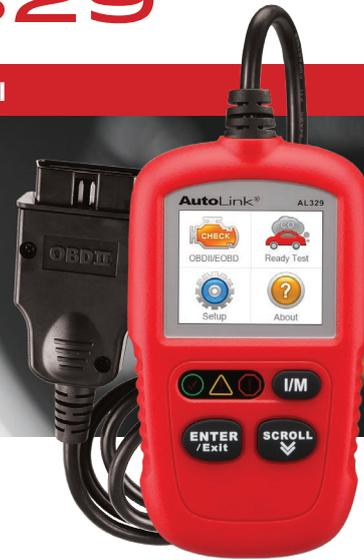
Dotato del pulsante brevettato “One-Click Readiness”, l’AutoLink AL329 consente di leggere e cancellare i codici diagnostici di errore (DTC) sul computer di bordo dei veicoli dal 1996 in poi compatibili con OBD II. La funzione AutoVIN fornita dallo strumento aiuta a identificare rapidamente i codici specifici del produttore. Visualizzando il monitor di prontezza I/M, l’AL329 è in grado di eseguire l’ispezione I/M.
